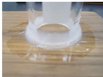
試験体とガラス管を接着
